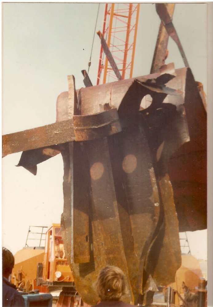
Stukje verwrongen scheepshuid verwijderen met de kraan van de Onrust.
